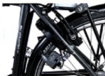
Alles Gute beieinander: Seitenläuferdynamo, Rahmenschlösser fürs Kurzzeit-Verschleißeln, Hydraulikbremsen, die auch im regnerischen Stadtverkehr sicher verzögern. Unten: Display des Bergamont, Wunsch aller Tester: Da Tasten sollten größer sein.
